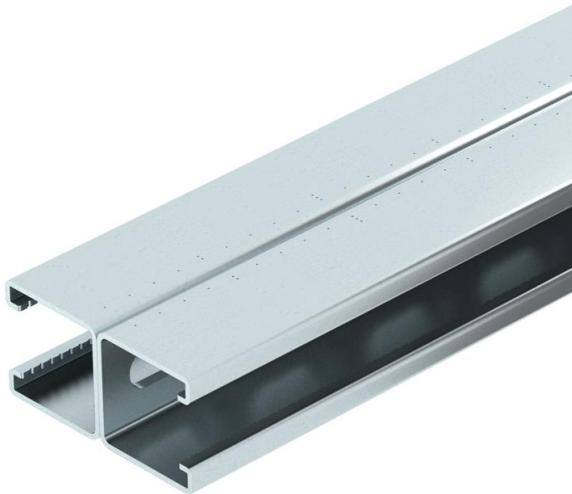
Profilato/guida di montaggio con foratura a pavimento in versione pesante e larghezza asola 22 mm. In versione doppia, ovvero due profilati sono collegati tra loro sul dorso (uniti con clinch).
