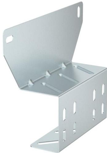
Montageplatte zur Befestigung von Kabelabzweigkästen der FireBox T-Serie (mit Außenbefestigung) an Kabelrinnen bzw. -leitern mit einer Seitenhöhe von 60 mm. Die abgewinkelte Bauform aus durch Sicken verstärktem Stahlblech ermöglicht die sichere Montage der Funktionserhaltkabel, ohne das Kabel über den Seitenholm biegen zu müssen.
