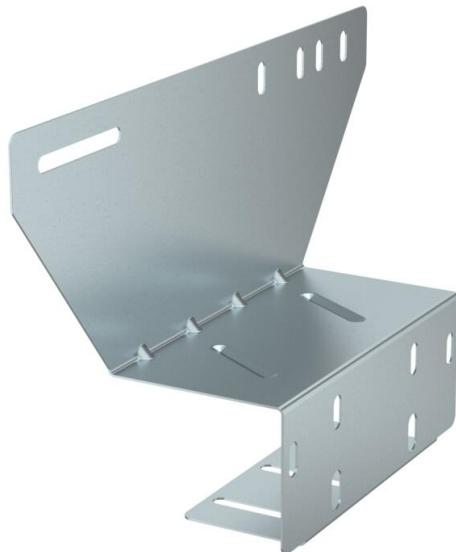
Piastra di montaggio universale per il fissaggio di FireBox serie T sulla parte anteriore delle passerelle portacavi, passerelle grigilate e passerelle a scaletta con altezza laterale max di 60 mm. Permette il montaggio sicuro dei cavi per il mantenimento funzionale senza doverli piegare. Idonea per tutte le FireBox.
