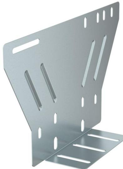
Plaque de montage universelle pour la fixation de la FireBox série T à l'arrière des chemins de câbles en treillis ainsi que des échelles de câbles avec une hauteur latérale max. de 60 mm. Permet un montage sûr du câble de sécurité de fonctionnement, sans que le câble ne doive être plié sur l'aile. Compatible avec toutes les FireBox.
