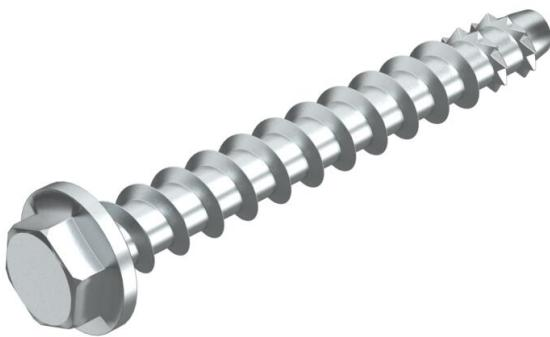
Tirante a vite per il montaggio diretto senza tassello in calcestruzzo fessurato e non fessurato nonché muratura. Con intaglio esagonale e rondella a pressione per grandi carichi. Idoneo per il fissaggio di profilati di sospensione e mensole a parete.
