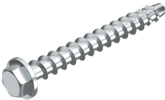
Vis d'ancrage pour le montage direct sans cheville dans de la maçonnerie et du béton fissuré et non fissuré. Avec entraînement hexagonal et rondelle pressée pour la fixation de charges importantes. Convient pour la fixation de pendants et consoles murales.
