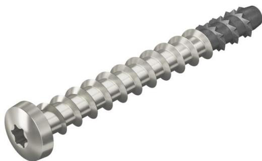
Edelstahl-Schraubanker zur direkten Montage ohne Dübel in gerissenem und ungerissenem Beton sowie Mauerwerk. Mit Rundkopf für universelle Befestigungen in Feuchträumen und Außenbereichen. Torx-Antrieb T30.
