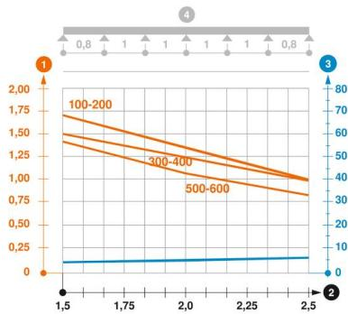
**Belastungsdiagramm Kabelrinne Typ MKSM 85**
