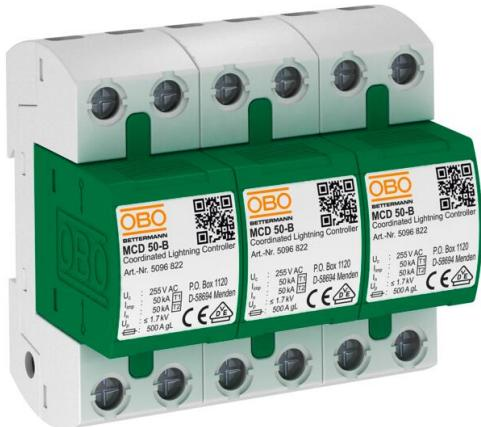
Entièrement préassemblé et prêt à raccorder, comprenant: 3 MCD 50-B: parafoudre coordonné de type 1+2 selon EN 61643-11. Pour interface 0 à 2 (LPZ) conformément au concept des zones de protection contre la foudre selon CEI 62305 ou VDE0185-305.
