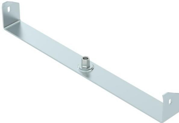
Mittenabhangung für Kabelrinnen mit eingerolltem Seitenholm in der Seitenhöhe 60 mm.
