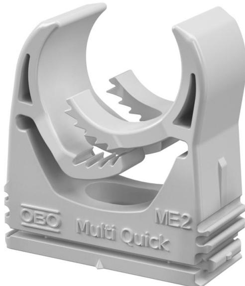
Gaffetta da parete per l'alloggiamento di tubi metrici e tubi per installazione elettrica Quick-Pipe. Intervallo di serraggio flessibile di diversi millimetri. Possibilità di fissaggio universali su pareti e soffitti in ambienti interni ed esterni. Montaggio tubi senza attrezzi. Possibilità di montaggio allineato anche con gaffette OBO Quick o starQuick.
