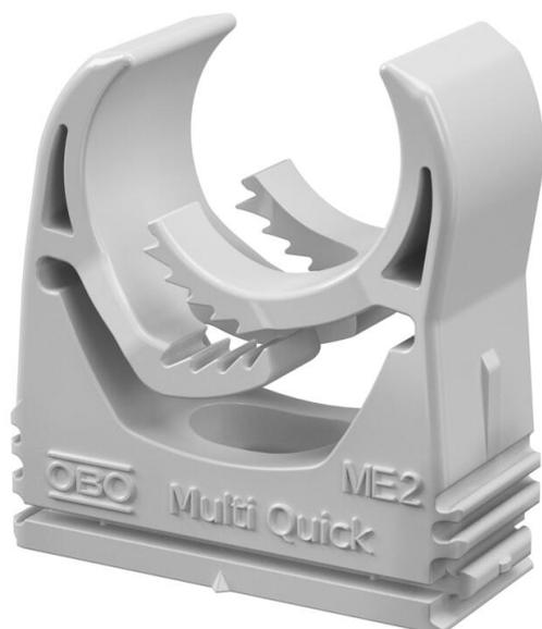
Aufputzschelle zur Aufnahme von metrischen Rohren sowie Elektroinstallationsrohr Quick-Pipe. Flexibler Spannungsbereich von mehreren Millimetern. Universelle Befestigungsmöglichkeiten an Wand und Decke im Innen- und Außenbereich. Werkzeuglose Rohrmontage. Aneinander reihbar auch mit OBO Quick- oder pro-Quick-Schelle.
