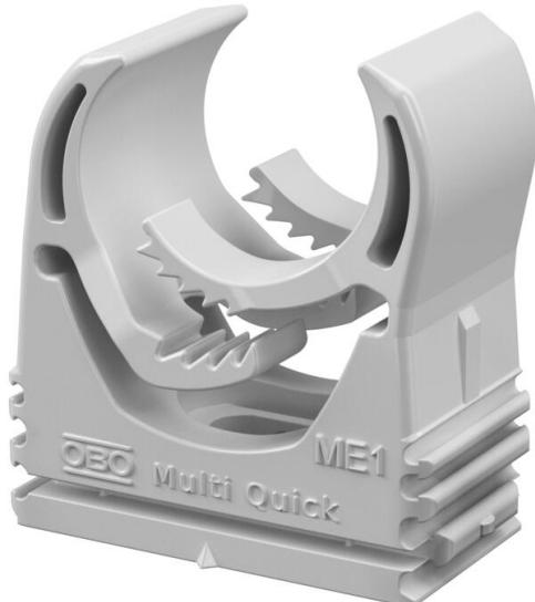
Collier en saillie pour la fixation de tubes métriques et de tubes d'installation électrique Quick-Pipe. Plage de serrage flexible de plusieurs millimètres. Possibilités de fixation universelles au mur et au plafond, en intérieur comme en extérieur. Montage de tubes sans outils. Possibilité de montage en série, y compris avec des colliers OBO Quick ou proQuick.
