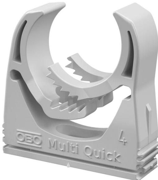
Collier en saillie pour la fixation de tubes métriques, de tubes PG et de tubes d'installations électriques Quick-Pipe. Plage de serrage flexible de plusieurs millimètres. Possibilités de fixation universelles au mur et au plafond, utilisation possible sur rail profilé en intérieur et dans des zones extérieures protégées. Montage de tubes sans outils. Possibilité de montage en série, y compris avec des colliers OBO Quick ou proQuick.
