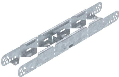
Multifunktionsverbinder zur Verbindung von Kabelleitern mit der Seitenhöhe 60mm. Es können symmetrische und asymmetrische Reduzierungen, stufenlose Bögen von 0-60° und Anbauabzweige erstellt werden.
