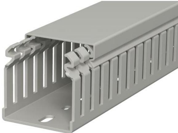
Canale di cablaggio a norma DIN EN 50085-2-3, incl. parte superiore e foratura nel fondo per posa orizzontale e verticale di cavi e linee elettriche nel quadro elettrico. Versione come canale DIN. La separazione delle lingue avviene senza utensili. Versione a filo possibile tramite punti di rottura predeterminati. Controllato secondo DIN EN 50085-2-3. Lunghezze speciali su richiesta.
