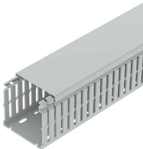
Canale di cablaggio privo di alogeni, a norma DIN EN 50085-2-3 incl. parte superiore e foratura nel fondo per posa orizzontale e verticale di cavi e linee elettriche nel quadro elettrico. Versione come canale DIN. La separazione delle linguette avviene senza utensili. Versione a filo possibile tramite punti di rottura predeterminati. Le giunzioni nelle asole laterali impediscono la fuoriuscita dei cavi. Controllato secondo DIN EN 50085-2-3. Lunghezze speciali su richiesta.
