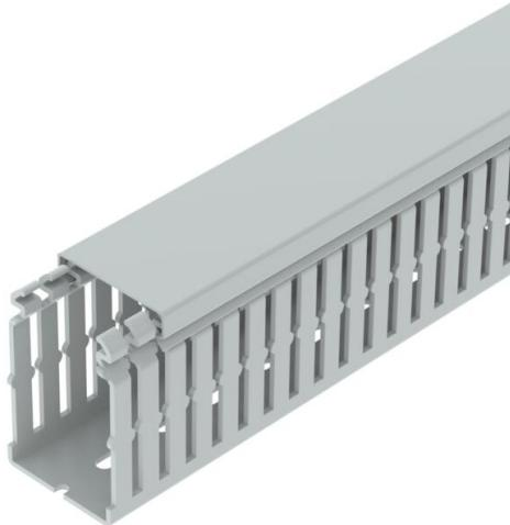
Goulotte de câblage sans halogène selon la norme DIN EN 50085-2-3 avec couvercle et fond perforé pour la pose horizontale et verticale des câbles et lignes électriques dans l'armoire électrique. Version goulotte DIN. La cassure des languettes s'effectue sans outil. La version affleurante avec le sol est possible pour une zone de rupture. Des rétrécissements dans les fentes latérales empêchent la chute des lignes. Testé selon DIN EN 50085-2-3. Longueurs spéciales sur demande.
