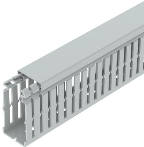
Goulotte de câblage sans halogène selon la norme DIN EN 50085-2-3 avec couvercle et fond perforé pour la pose horizontale et verticale des câbles et lignes électriques dans l'armoire électrique. Version goulotte DIN. La cassure des languettes s'effectue sans outil. La version affleurante avec le sol est possible pour une zone de rupture. Des rétrécissements dans les fentes latérales empêchent la chute des lignes. Testé selon DIN EN 50085-2-3. Longueurs spéciales sur demande.
