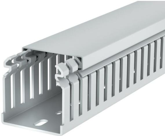
Canale di cablaggio privo di alogen, a norma DIN EN 50085-2-3 incl. parte superiore e foratura nel fondo per posa orizzontale e verticale di cavi e linee elettriche nel quadro elettrico. Versione come canale DIN. La separazione delle linguette avviene senza utensili. Versione a filo possibile tramite punti di rottura predeterminati. Controllato secondo DIN EN 50085-2-3. Lunghezze speciali su richiesta.
