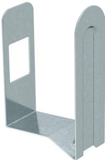
Le clip raidisseur pour goulotte maintient les câbles posés dans la goulotte et facilite ainsi l'installation au mur et au plafond. Les clips raidisseurs pour goulotte sont enfichés dans la lamelle perforée et s'encliquettent dans la paroi latérale. Convient aux largeurs de goulotte de 100 mm.
