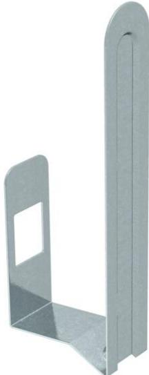
Die Kanalklammer hält die eingelegten Kabel und Leitungen im Kanal und erleichtert somit die Installation an Wand und Decke. Die Kanalklammern werden auf die Schlaufenlochung aufgesteckt und an der Seitenwand eingerastet. Passend für Kanalbreite 150 mm und 200 mm.
