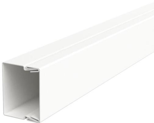
Couvercle de la goulotte et partie inférieure avec perforation au fond. La liaison équipotentielle est assurée sans accessoire supplémentaire entre la partie inférieure et couvercle. La goulotte de distribution LKM de type LKM 20030 a été testée comme système de pose pour le maintien en fonction selon DIN 4102 partie 12. Veuillez prendre en considération les types de câbles testés destinés au domaine des systèmes de protection anti-incendie BSS.
