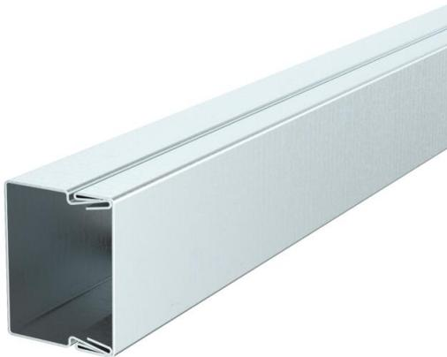
Couvercle de la goulotte et partie inférieure avec perforation au fond. La liaison équipotentielle est assurée sans accessoire supplémentaire entre la partie inférieure et couvercle. La goulotte de distribution LKM de type LKM 20030 a été testée comme système de pose pour le maintien en fonction selon DIN 4102 partie 12. Veuillez prendre en considération les types de câbles testés destinés au domaine des systèmes de protection anti-incendie BSS.
