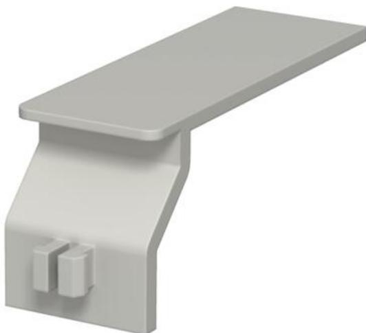
Barette porte-câble pour les canaux de câblage type LK4 et LK4 N. La barrette porte-câbles empêche la chute des câbles déjà posés. Grâce aux points de rupture, la longueur des diverses largeurs de goulotte peut être réduite à 38, 28 et 23 mm.
