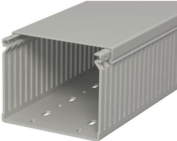
Goulotte de câblage avec couvercle et fond perforé pour la pose horizontale et verticale des câbles et lignes électriques dans l'armoire électrique. Version goulotte métrique. La dimension nominale de la taille du système correspond à la dimension intérieure des goulettes. La cassure des languettes s'effectue sans outil. La version affleurante avec le sol est possible pour une zone de rupture. Testé selon DIN EN 50085-2-3. Longueurs spéciales sur demande.
