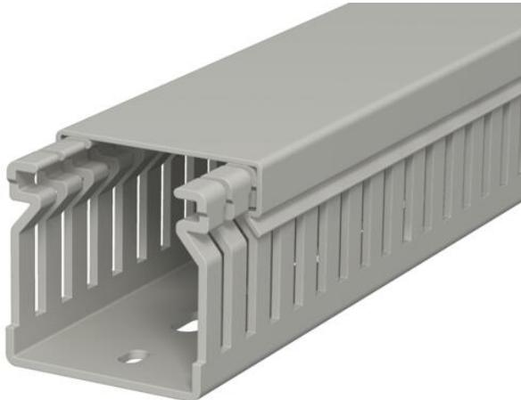
Canale di cablaggio, incl. parte superiore e foratura nel fondo per posa orizzontale e verticale di cavi e linee elettriche nel quadro elettrico. Versione come canale metrico. La misura nominale della grandezza di sistema corrisponde alla misura interna dei canali. La separazione delle linguette avviene senza utensili. Versione a filo possibile tramite punti di rottura predeterminati. Controllato secondo DIN EN 50085-2-3. Lunghezze speciali su richiesta.
