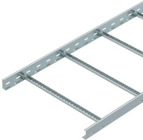
Kabelleiter mit gelochtem Seitenholm in der Seitenhöhe 60 mm mit eingenieteten, nach oben offenen C-Profil-Sprossen (Ausführung VS).
