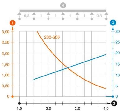
Diagramme de charge de l'échelle à câbles de type LG 60 VS
