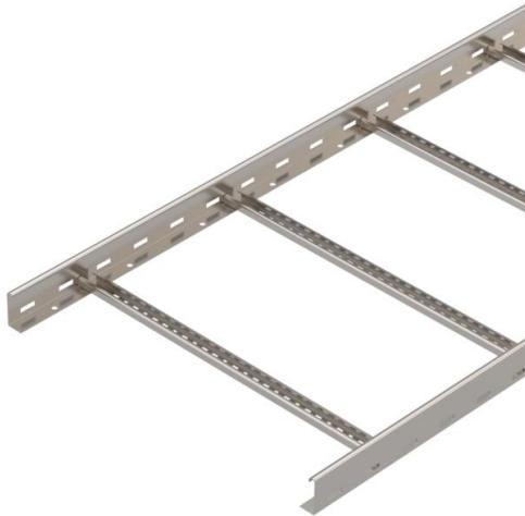
Échelle à câbles avec longeron perforé d'une hauteur de 60 mm, avec échelons VS rivetés (profilé en C) ouverts vers le haut.
