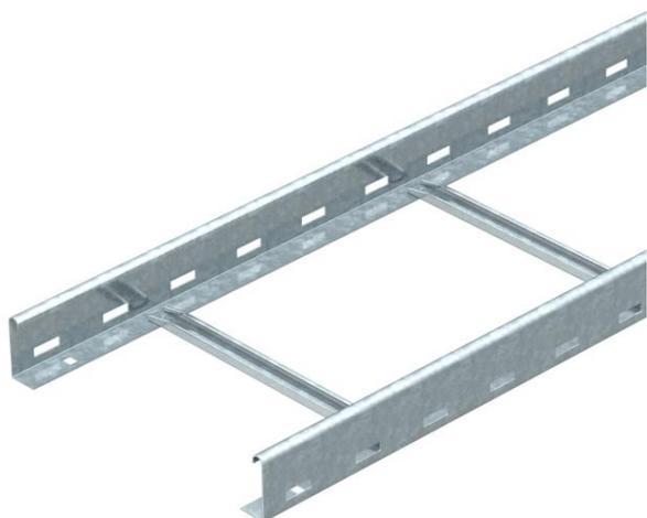
Kabelleiter mit gelochtem Seitenholm in der Seitenhöhe 60 mm mit eingieteten, nach oben offenen C-Profil-Sprossen (Ausführung NS). Die Kabelleiter wird in zusammengeklappter Ausführung geliefert. Die passende Bügelschelle vom Typ 2056N finden Sie im Abgriff Steigleiter-Systeme.
