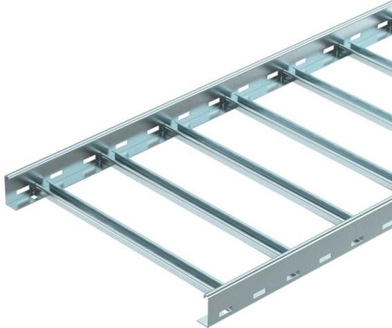
Échelle de câbles pour la pose horizontale de câbles et de conduits. Dans les largeurs 200 - 400 mm, peut être utilisé comme structure porteuse normalisée pour le maintien de la fonction selon DIN 4102 partie 12 Classes de maintien en fonction E30 à E90. Avec un échelon profilé en C riveté et ouvert en haut.
