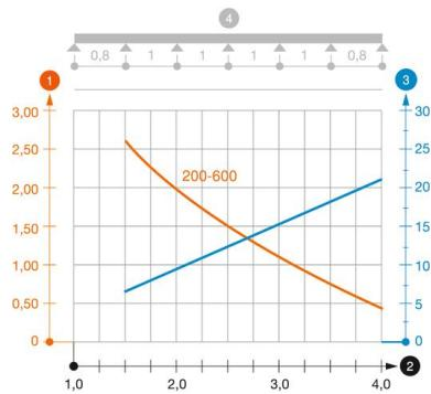
Diagramme de charge de l'échelle à câbles LG 60 NS
