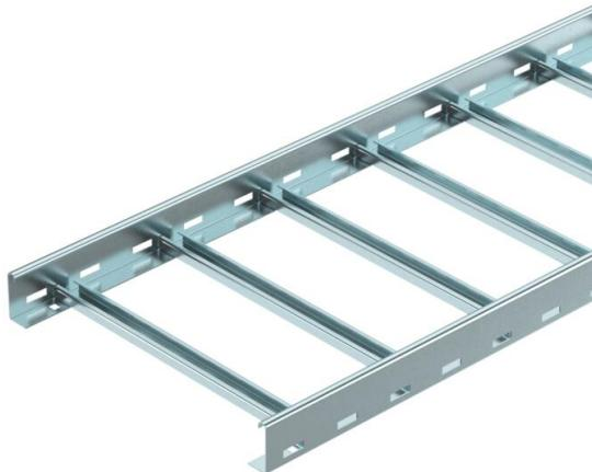
Échelle de câbles pour la pose horizontale de câbles et de conduits. Dans les largeurs 200 - 400 mm, peut être utilisé comme structure porteuse normalisée pour le maintien de la fonction selon DIN 4102 partie 12 Classes de maintien en fonction E30 à E90. Avec un échelon profilé en C riveté et ouvert en haut.
