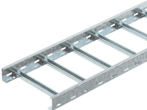
Échelle de câbles pour la pose horizontale de câbles et de conduits. Dans les largeurs 200 - 400 mm, peut être utilisé comme structure porteuse normalisée pour le maintien de la fonction selon DIN 4102 partie 12 Classes de maintien en fonction E30 à E90. Avec un échelon profilé en C riveté et ouvert en haut.
