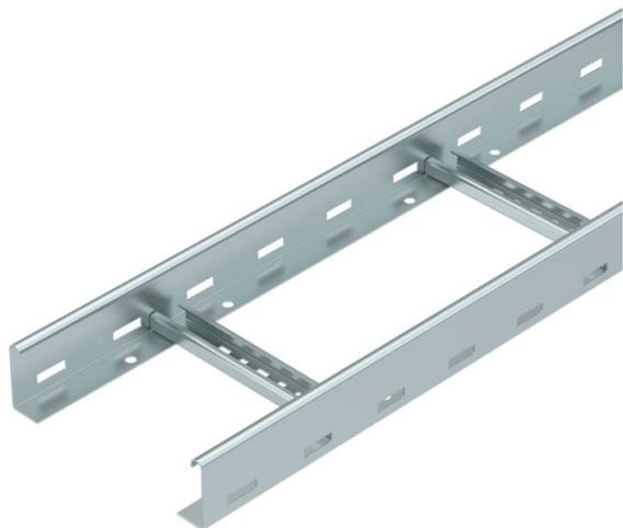
Passerella con longherone forato, con bordo di altezza pari a 60 mm, pioli del profilato a C rivettati e aperti verso l'alto (versione VS). La passerella a scaletta viene fornita in versione ripiegata.
