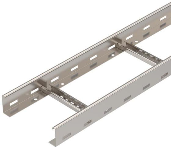
Kabelleiter mit gelochtem Seitenholm in der Seitenhöhe 60 mm mit eingenieteten, nach oben offenen C-Profil-Sprossen (Ausführung VS).
