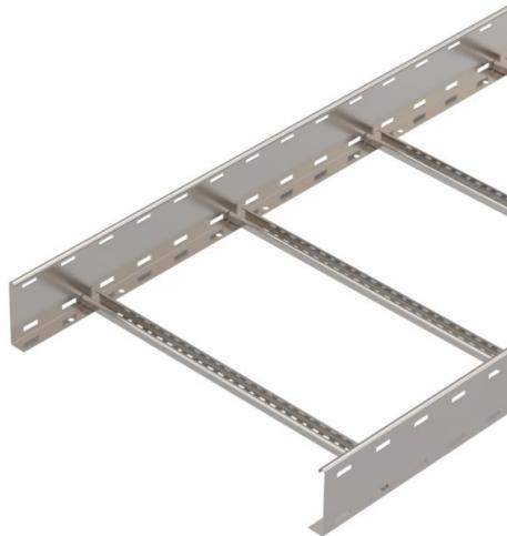
Échelle à câbles avec longeron latéral perforé d'une hauteur latérale de 110 mm, avec échelons rivetés à profilé en C ouvert vers le haut. L'échelle à câbles est livrée repliée.
