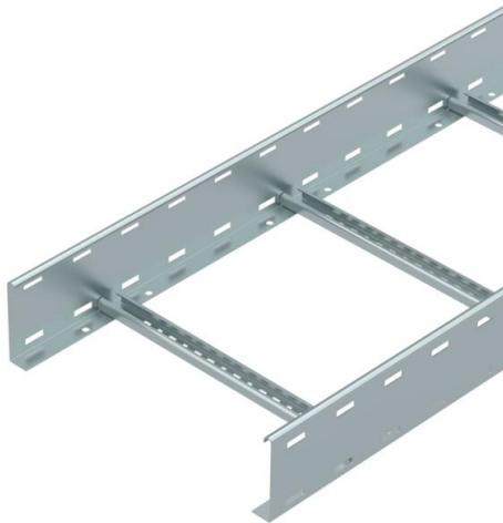
Échelle à câbles avec longeron latéral perforé d'une hauteur latérale de 110 mm, avec échelons rivetés à profilé en C ouvert vers le haut.
