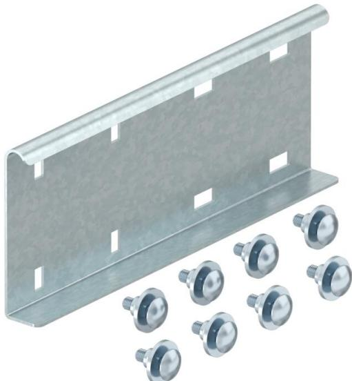
Éclisse de dilatation pour compenser la dilatation thermique linéaire. Les couples de serrage des vis autobloquantes du côté du palier flottant sont de 5 Nm.
