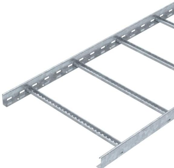
Passerella con bordo di altezza pari a 60 mm, con pioli del profilato C30 aperti verso l'alto saldati. Longherone laterale arrotondato come rinforzo e protezione dei bordi. Il fissaggio alla mensola viene eseguito con morsetti tipo LKS 40. La misura della scanalatura del piolo è pari a 16,5 mm, la staffa reggicavo è il tipo 2056.
