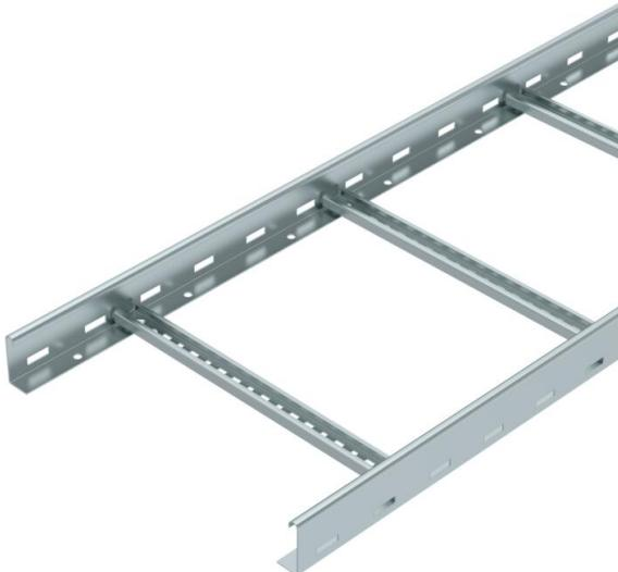
Passerella con bordo di altezza pari a 60 mm, con pioli del profilato C30 aperti verso l'alto saldati. Longherone laterale arrotondato come rinforzo e protezione dei bordi. Il fissaggio alla mensola viene eseguito con morsetti tipo LKS 40. La misura della scanalatura del piolo è pari a 16,5 mm, la staffa reggicavo è il tipo 2056.
