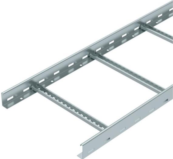
Kabelleiter in Seitenhöhe 60 mm mit eingeschweißten, nach oben offenen C30 Profilsprossen. Eingerollter Seitenholm zur Verstärkung und als Kantenschutz. Die Befestigung auf dem Ausleger erfolgt mit Klemmstücken Typ LKS 40. Das Schlitzmaß der Sprosse beträgt 16,5 mm, die passende Bügelschelle ist der Typ BS-H....
