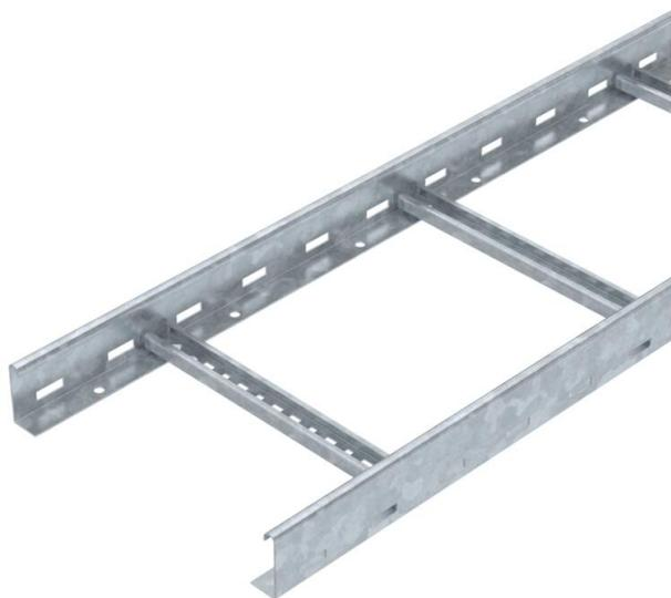
Passerella con bordo di altezza pari a 60 mm, con pioli del profilato C30 aperti verso l'alto saldati. Longherone laterale arrotondato come rinforzo e protezione dei bordi. Il fissaggio alla mensola viene eseguito con morsetti tipo LKS 40. La misura della scanalatura del piolo è pari a 16,5 mm, la staffa reggicavo è il tipo 2056. Schermatura elettromagnetica senza coperchio 10 dB, con coperchio 15 dB.
