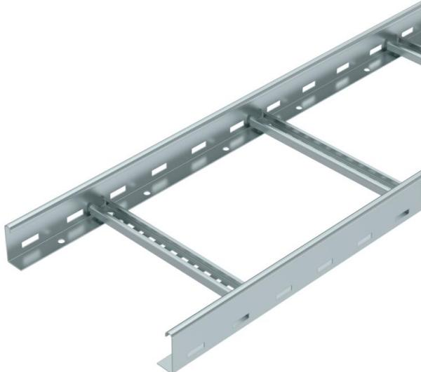
Passerella con bordo di altezza pari a 60 mm, con pioli del profilato C30 aperti verso l'alto saldati. Longherone laterale arrotondato come rinforzo e protezione dei bordi. Il fissaggio alla mensola viene eseguito con morsetti tipo LKS 40. La misura della scanalatura del piolo è pari a 16,5 mm, la staffa reggicavo è il tipo BS-H....
