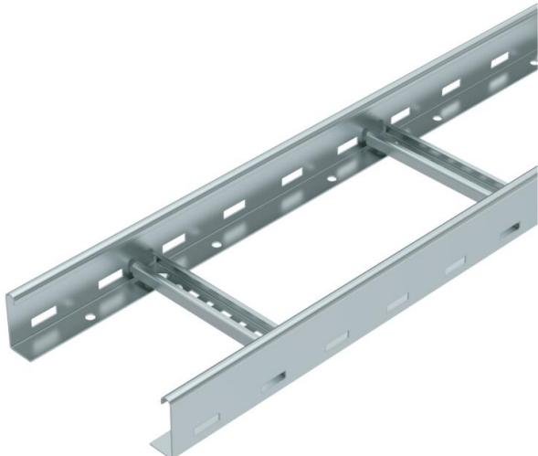
Kabelleiter in Seitenhöhe 60 mm mit eingeschweißten, nach oben offenen C30 Profilsprossen. Eingerollter Seitenholm zur Verstärkung und als Kantenschutz. Die Befestigung auf dem Ausleger erfolgt mit Klemmstücken Typ LKS 40. Das Schlitzmaß der Sprosse beträgt 16,5 mm, die passende Bügelschelle ist der Typ BS-H....
