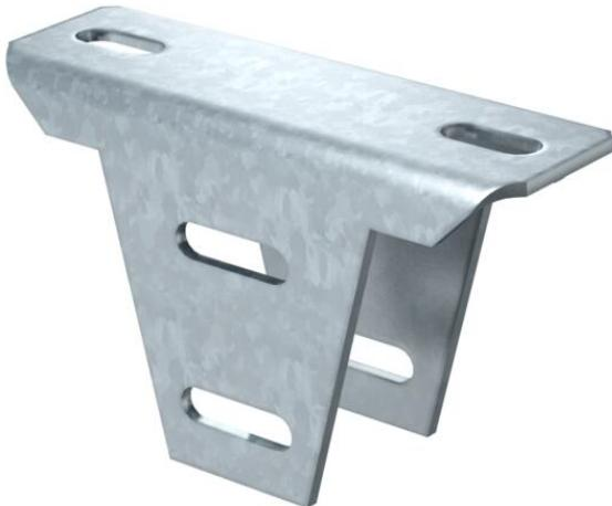
Plaque de tête orientable pour le montage sur des montants US 5. En association avec le montant US 5, toutes les longueurs de pendarde peuvent être fabriquées sur place. Avec la plaque de tête orientable, il est possible de compenser les suspensions inclinées jusqu'à 30°. L'entretoise DSK 47 est utilisée lors du montage de la plaque de tête à des fins de stabilisation. Le réglage maximal d'angle est d'env. 30° sur un côté. Livraison sans vis SKS 10 x 80, ni entretoise DSK 47.
