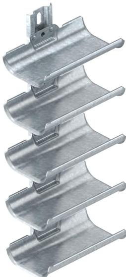
Kabeltragwannen für eine schnelle und einfache Kabelverlegung in Einsatzgebieten, in denen herkömmliche Kabeltragsysteme aus Platzgründen nicht montiert werden können. Die Kabeltragwannen verfügen über eine große Auflagefläche und abgerundete Außenkanten zum Schutz der Kabel.
