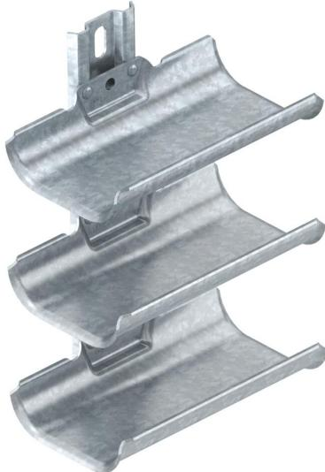
Les gouttières support de câbles sont destinées à une pose simple et rapide dans des zones n'offrant pas un espace suffisant pour montage de systèmes de support de câbles courants. Les gouttières support de câbles dispose d'une grande surface d'appui et de bords extérieurs arrondis pour protéger les câbles. Conformément à la norme DIN VDE 0298-300, ne pas dépasser un écart max. d'appui de 0,8 mm.
