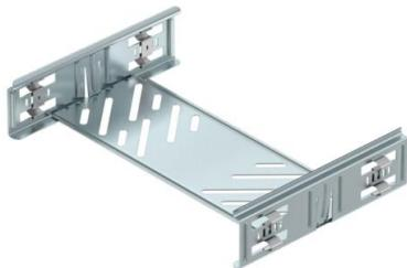
Giunto con fissaggio rapido per il collegamento senza viti di passerelle forate con altezza laterale pari a 60 mm.
