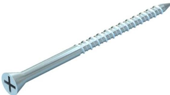
Senkkopfschraube als Ersatzteil für Brandschutzkanal PYROLINE® Con, zur Befestigung von Deckel, Endstück, Wandanschlusskragen und Aufdoppelungsstück mit einer Plattendicke von 40 - 60 mm.
